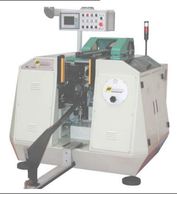
MACCHINA AUTOMATICA PER L' INFILATURA DEI RAGGI NEI MOZZI
